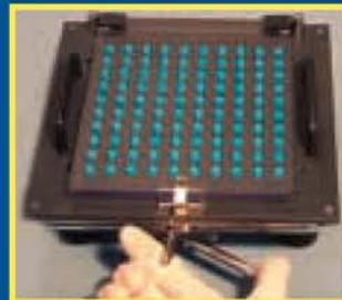
**7.** Cierre la placa de cerrado del Llenador y deslice la abrazadera para asegurar. Coloque el pulgar sobre la marca del pulgar y apriete la palanca de la cama para asegurar los cuerpos en el Llenador.
