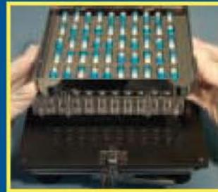
**3.** Abra la placa de cerrado del Llenador y coloque el Orientador localizando las patas en los hoyos sobre el Llenador marcados "I".
