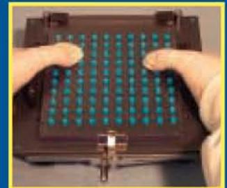
**12.** Coloque la charola de las cápsulas de nuevo en el Llenador. Para cerrar las cápsulas, empuje hacia abajo la placa de cerrado con los pulgares mientras jala hacia arriba la placa de elevación (no visible) con los dedos.
