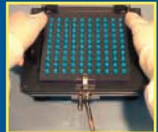
**8.** Para separar las cápsulas, presione los pulgares hacia abajo en las agarraderas del Llenador mientras levanta hacia arriba la charola de las cápsulas con los dedos. Después de la separación, suelte la palanca de la cama para dejar caer los cuerpos de las cápsulas al ras con el Llenador.
